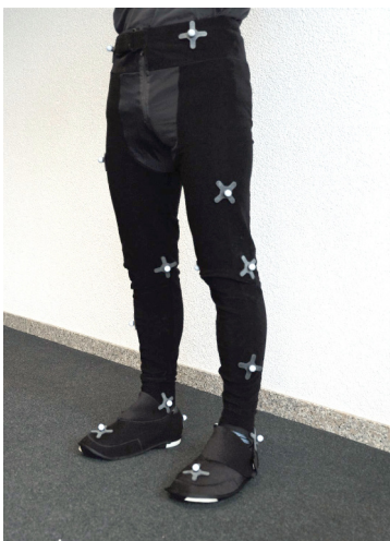
Abbildung 1: Links: «Plug-in Gait» Lower Body mit vKAD Marker-Platzierung, Rechts: 3D-Maker (rechtes Bein: grün, linkes Bein: rot, mediale Marker: gelb).
